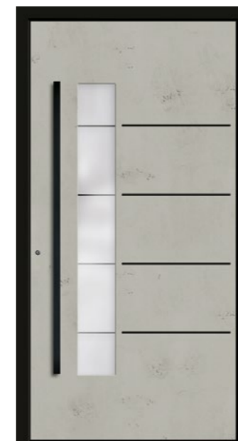
Modell 40558-1 Aluminium* Modell 20558-1 Kunststoff* Variante: Kontur, mit äußerem Vollblatt-Design, außen mit schwarzen Lisenen 3fach-Glas: Mattiertes Glas mit klaren Streifen G1440 Griff: HA1550-160 schwarz
