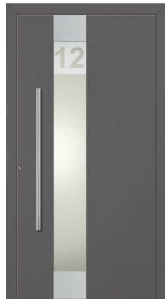
Modell 40554-5 Aluminium Variante: Kontur mit äußerem Vollblatt-Design mit Alu-Applikationen außen 3fach-Glas: Sandstrahlung Numira 1 Ziffer und großes Feld klar, Hintergrund matt Griff: HA1038-100 Edelstahl
