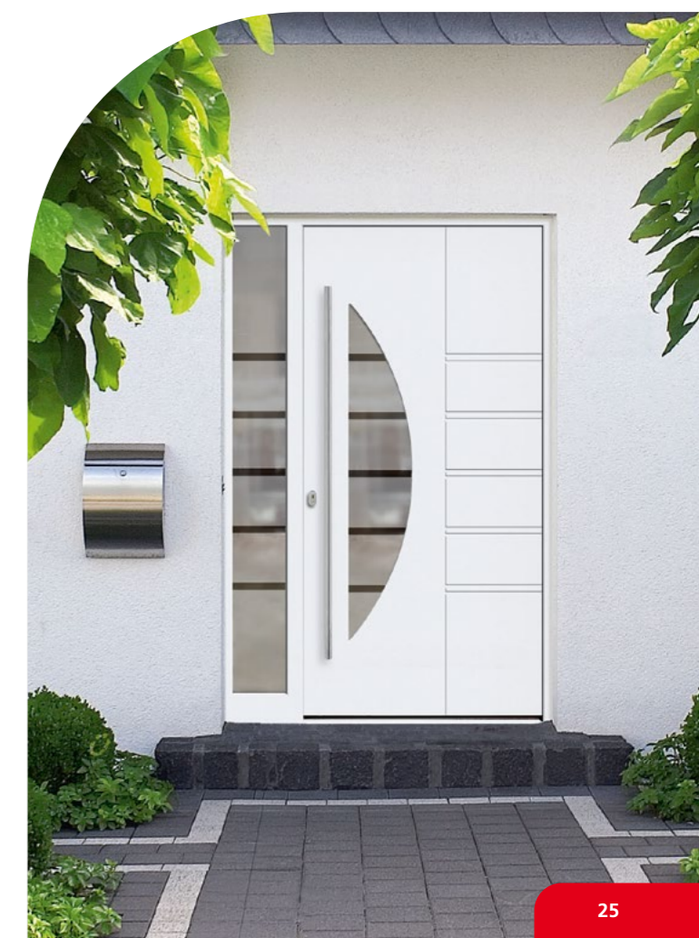
Modell 20144-1 Kunststoff Modell 40144-1 Aluminium Variante: Kontur mit äußerem Vollblatt-Design, außen mit Nuten Modell 30144-1 Holz 3fach-Glas: Mattiertes Glas mit klaren Streifen G961 Griff: HA1038-160 Edelstahl PZ-Rosette: HA1077 Edelstahl mit Kernziehschutz (oval)
