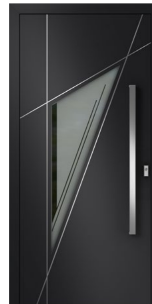
Modell 20445 Kunststoff Modell 40445 Aluminium Variante: Kontur, mit äußerem Vollblatt-Design Außen matte Lisenen aus Edelstahl, innen Ziernuten 3fach-Glas: Designglas „Arzberg“, Klarglas mit Teilmattierung Griff: HA1550-80 Edelstahl PZ-Rosette: HA1541 Edelstahl mit Kernziehschutz (eckig)
